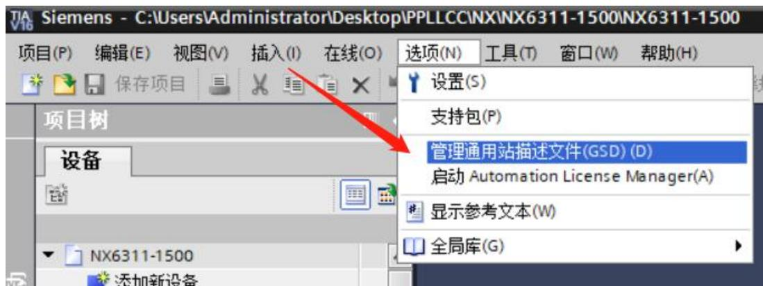
在打开的“管理通用站描述文件”里面输入“C:\ProgramData\Siemens\Automation\Portal V16\data\xdd\gsd\gsdml-v2.32-blueone-hj3204-2-4eff-20210519”
